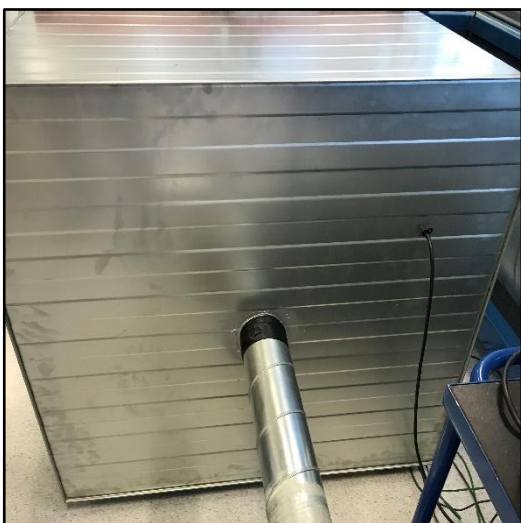
Figur 5: Blindlokk med påmontert Ø100 mm stuss
